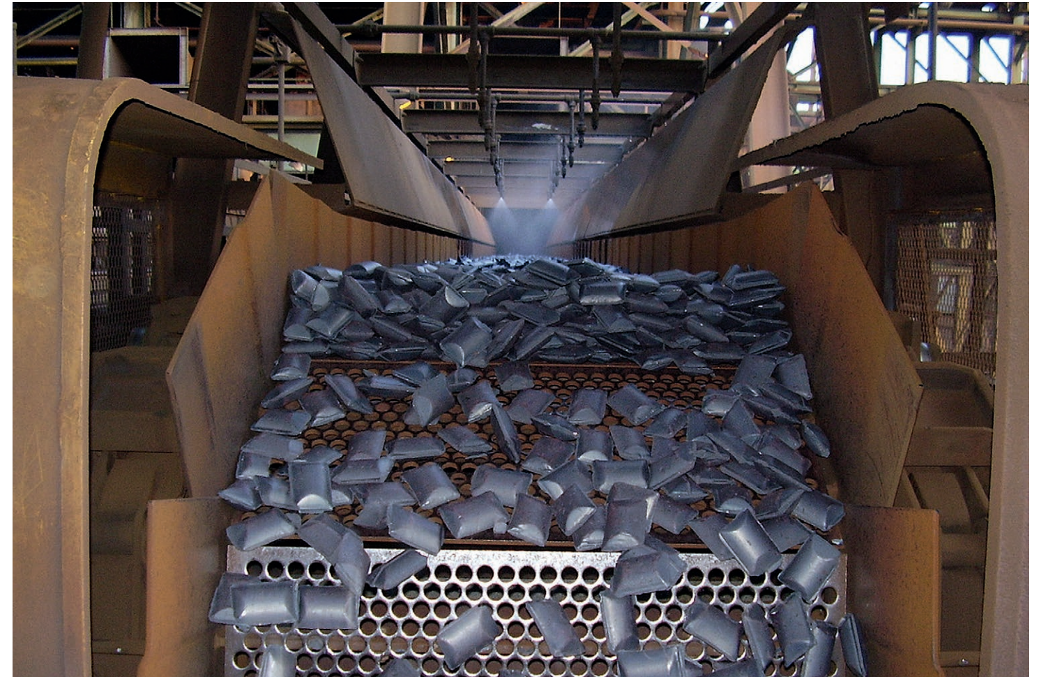
El briquetado en caliente representa una alternativa moderna al proceso de altos hornos
